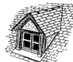
Fig. 9 Lucarne jacobine, en bâtière ou à chevalet
